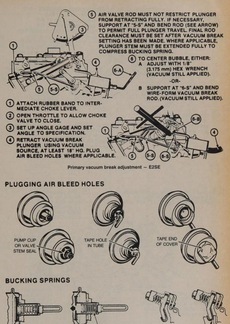
PLUNGER STEM EXTENDED (SPRING COMPRESSED)
